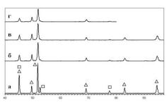
Рис. 7. Рентгенограмма порошков Ru-Al-(Re). а — исходная смесь; б — механоактивация 5 часов; в — 10 ч.; г — 15 ч.
