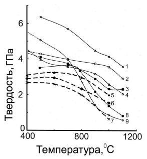
Рис. 12. Характерные зависимости «кратковременной» горячей твердости некоторых сплавов на основе RuAl и других моноалюминидов (ат. %):
