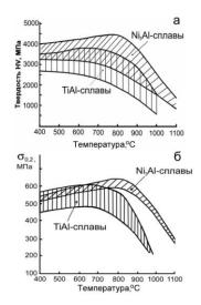
Рис.9. Температурная зависимость твердости (HV) (а) и пределов текучести ( $\sigma_{0,2}$ ) (б) сплавов на основе TiAl и сплавов на основе Ni<sub>3</sub>Al типа BKHA.
