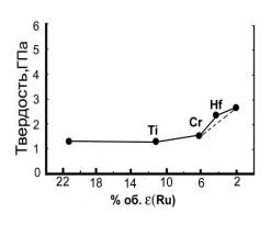
Рис. 11. Влияние объемной доли ε (Ru) и легирующих элементов на длительную твердость при 1000°C сплавов на основе RuAl
