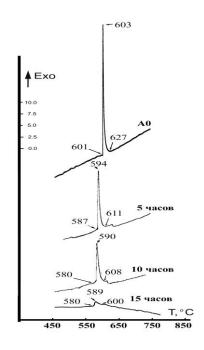
Рис. 6. Влияние времени аттритирования на температуру и величину экзотермического эффекта реакции Ru+Al→RuAl
