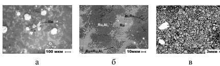
Рис. 8. Характерные микроструктуры сплава 49Ru-48Al-3Re, полученного по III схеме консолидации: а, б -A0, в -A15
