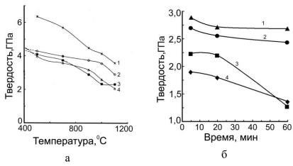
Рис. 10. Характерные зависимости кратковременной (а) и длительной (б) горячей твердости сплавов на основе RuAl (ат. %): 1 - Ru-49Al; 2 - Ru-39,4Al-5,46Hf; 3 – Ru-40Al; 4 – Ru-38%Al-4,4Ti
